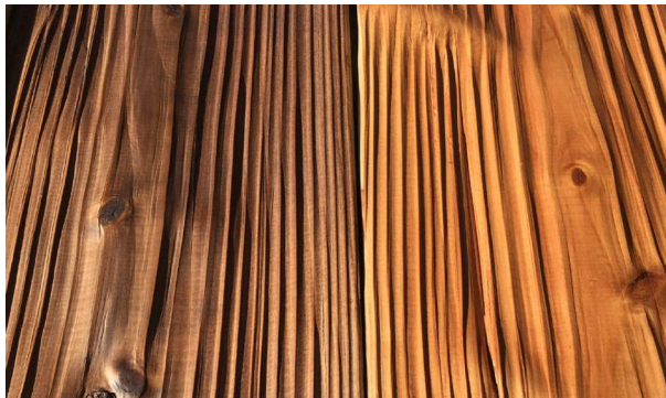
凸凹Gywood®に柿渋で染色した板。
